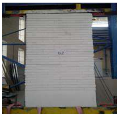
شکل (۱۰) نصب دیوار B2 بر روی دستگاه بارگذاری
