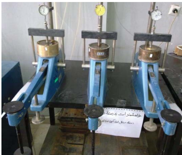
شکل ۵) دستگاه آزمایش تحکیم مورد استفاده
