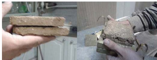
شکل ۴) نمونه‌هایی از نحوه شکست نمونه پس از انجام آزمایش مقاومت برش مستقیم
