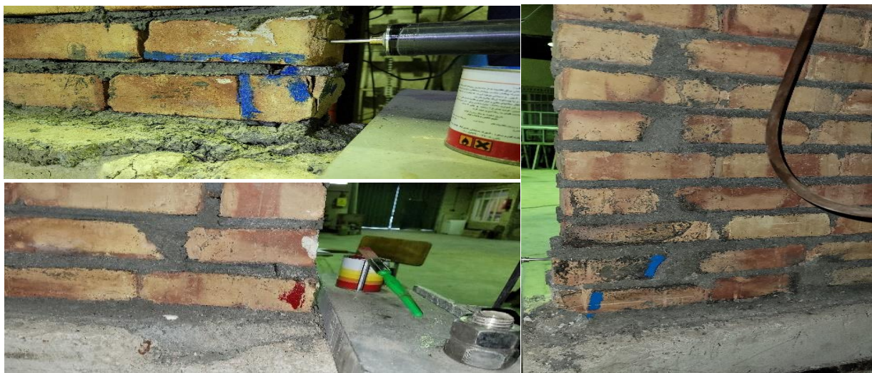
شکل ۱۰: ترک های سمت راست دیوار در ۲ رفت و برگشت جابه جایی ۴.۸mm
