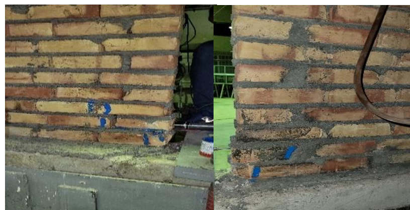
شکل ۱۱: آسیب های دیوار در انتهای جابه جایی ۷.۲mm
