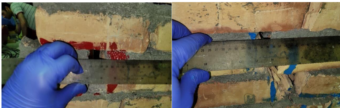
شکل ۱۵: اندازه گیری عرض ترک نمونه ۱
