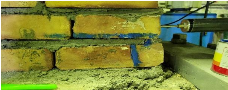
شکل ۹: ترک های پنجه سمت راست دیوار در ۲ رفت و برگشت جابه جایی ۴.۸mm
