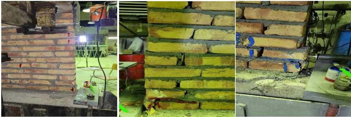
شکل ۱۲: آسیب های دیوار در انتهای جابه جایی ۷.۲mm
