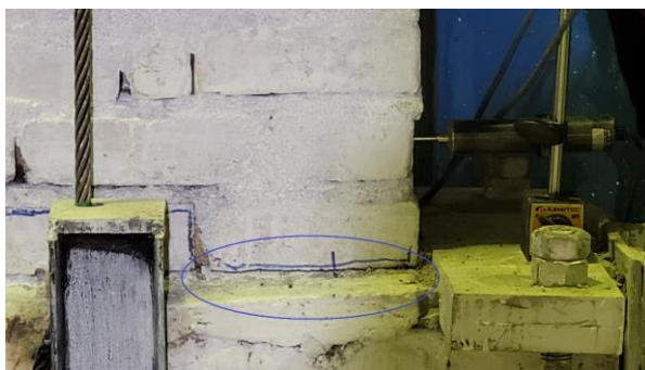
شکل ۳۲: بلند شدگی پاشنه دیوار در دریفت نسبی 0.30\%
