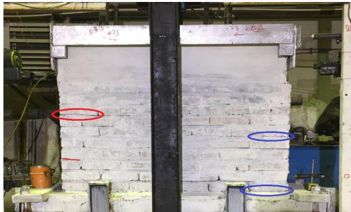
شکل ۲۶: وضعیت گسترش ترک‌ها در دررفت نسبی ۰.۱۵٪
