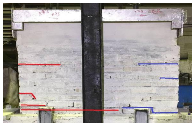
شکل ۲۹: آسیب‌های دیوار در پایان مرحله اول آزمایش
