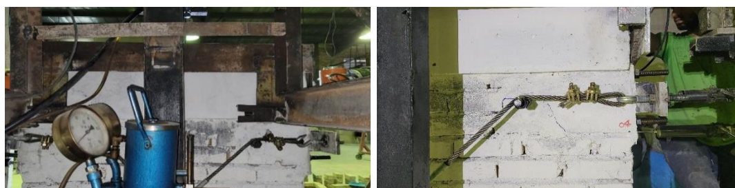
شکل ۲۳: ترک‌های ایجاد شده دریافت نسبی ۰.۲٪
