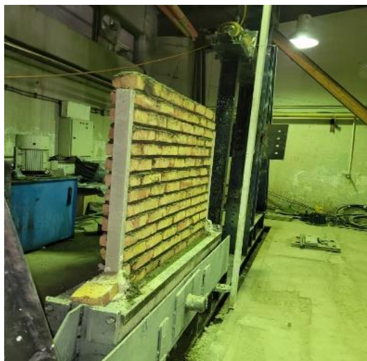
شکل ۳: نمونه دیوار مصالح بنایی مورد آزمایش
