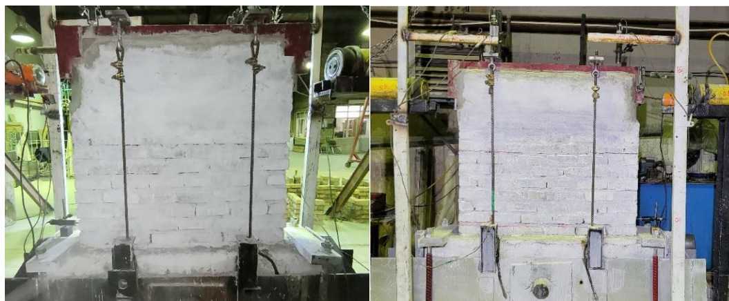
شکل ۳۱: نمونه تقویت شده بدون سربار با تاندون های فولادی (تصویر دو وجه مختلف دیوار)
