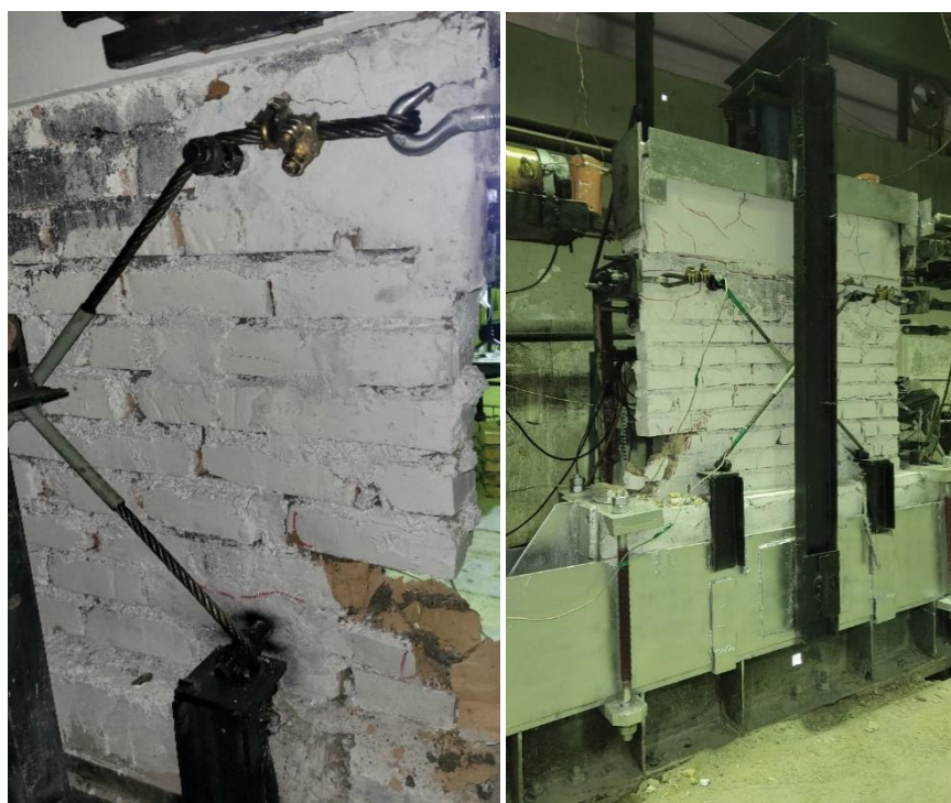
شکل ۲۷: وضعیت نهایی دیوار در دررفت نسبی ۱٪
